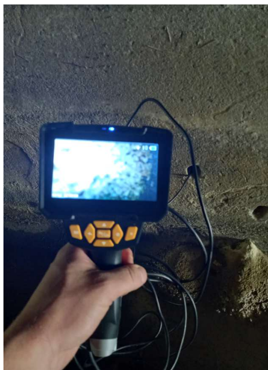
Pohled endoskopem do vývrtů v opěrách, na více místech i více výškových úrovních – vždy byl objeven základ sousedního domu, který je minimálně ve výškové úrovni paty opěry
